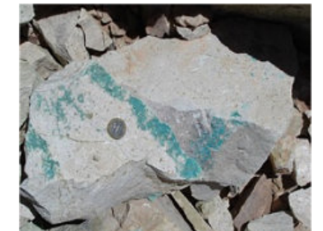
Figura 11: Granodiorita de hornblenda y biotita, con mineralización de cobre.
