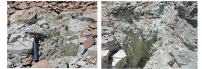
Figura. 5.14: Estilos de mineralización presentes en el sector S del área: A) vetillas de crisocola intercrecida con epidota y cuarzo. B) Plano de falla relleno con crisocola.
